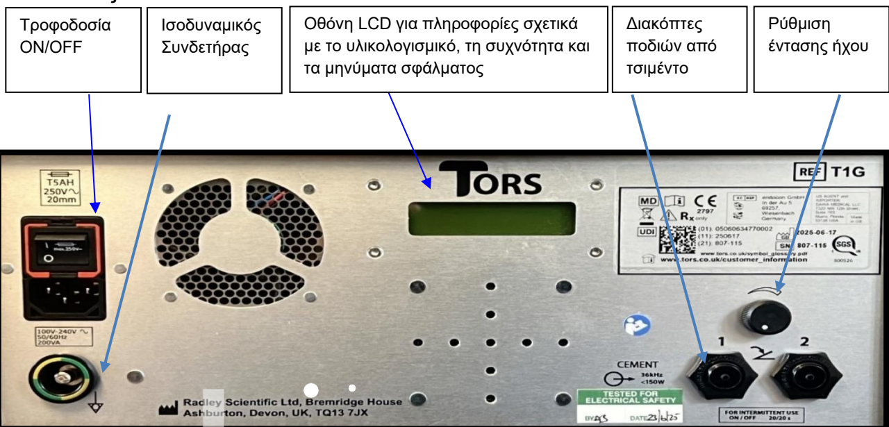
Εικόνα 2: Πίσω πίνακας γεννήτριας TORS
